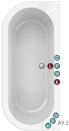
Centerutförande OBS! På BK1675LFD placeras blandaren i hörnet, ej på långsidan (alt.2 ovan).
